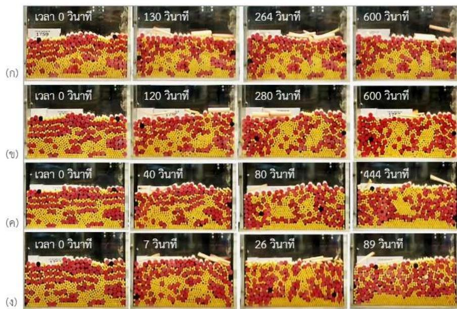
ภาพที่ 4 การเคลื่อนที่ของวัสดุเม็ดที่ใช้วัสดุผนังชนิดต่าง ๆ ได้แก่ ผนังกระดาษฟอยล์ ( $\mu = 0.376$ ) (ก) ผนังอะคริลิค ( $\mu = 0.432$ ) (ข) ผนังกระดาษ ทรายเบอร์ 400 ( $\mu = 0.790$ ) (ค) และผนัง กำมะหยี่ ( $\mu = 0.825$ ) (ง) เมื่อเริ่มต้นลักษณะการจัดเรียงแบบสุม
