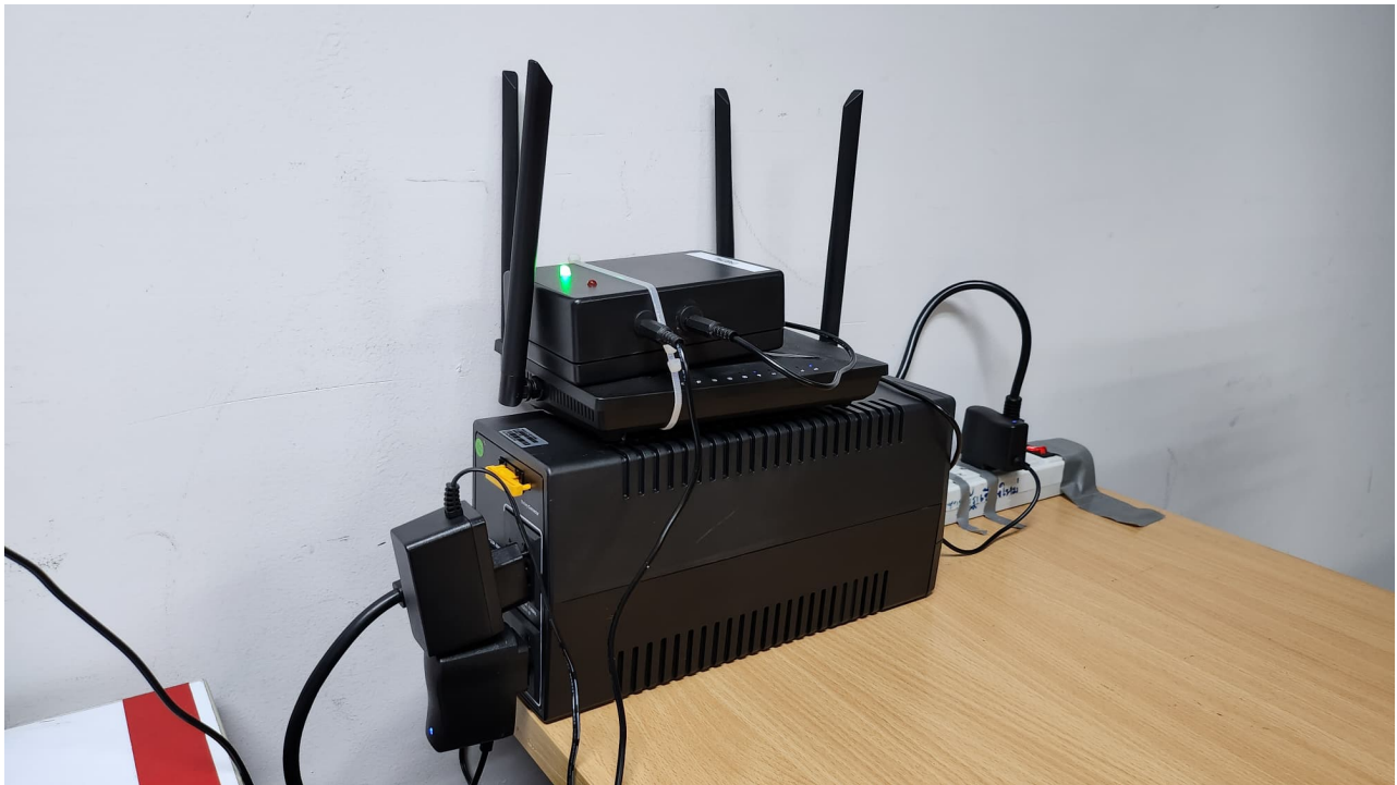
ภาพอุปกรณ์ IoT แจ้งเตือนเมื่อมีเหตุการณ์ไฟดับ ไม่สามารถบริการเครือข่ายอินเทอร์เน็ต
